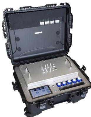
Le PANDa, grâce à sa technique de Voltamétrie par stripping anodique (Square wave voltametry), est capable de détecter le Cuivre dans les eaux usées, industriels et potable avec une L.O.D de 2 µg/L.
